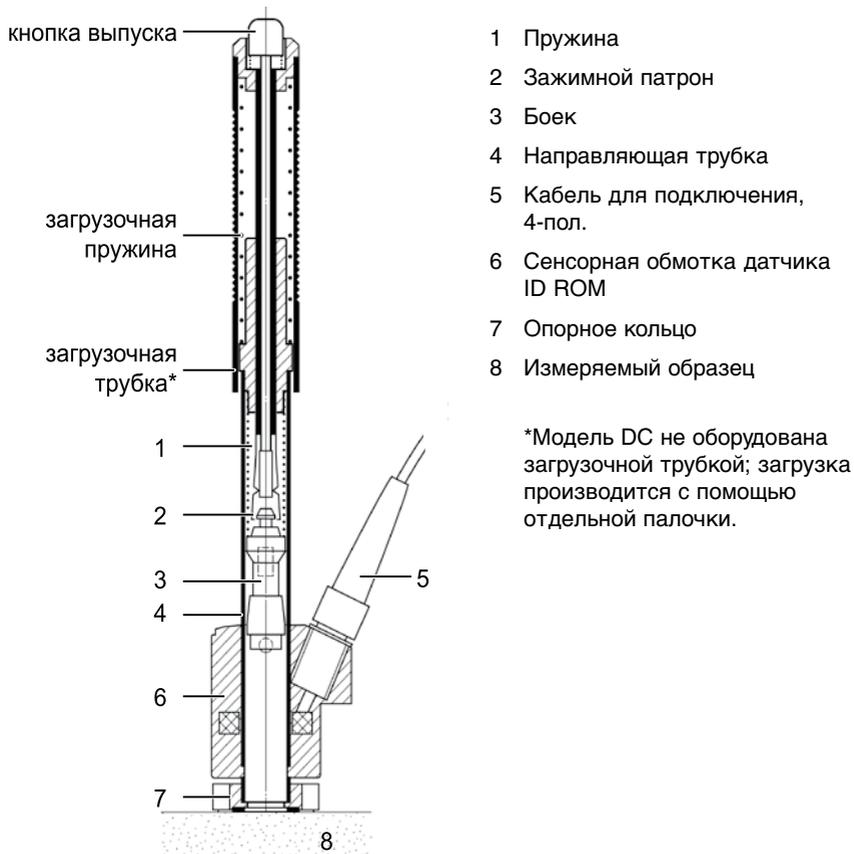
Рис. 2.02 Разрез датчика
