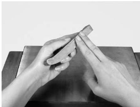
Рис. 6.01 Применение притирочной смазки
