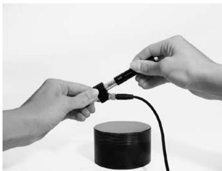
Рис. 6.05 Взвод бойка датчика
