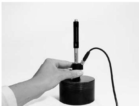
Рис. 6.06 Установка на поверхности образца
