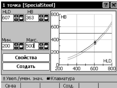
▶ В поле ввода наверху слева ("HLD" в данном примере) введите измеренную твердость  $L_1$  в шкале HL датчика.
