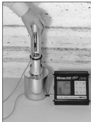
Рис. 6.1 Проверка производительности молотка для испытаний бетона
