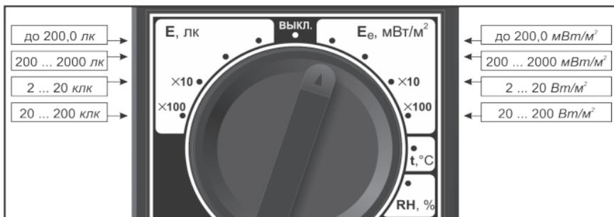
Рис. 2. Поддиапазоны измерения световых параметров
