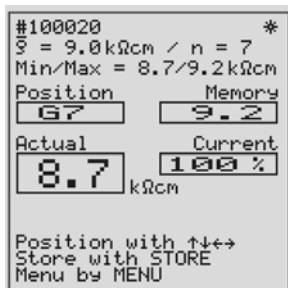
Рис. 7.2 Режим измерения удельного электрического сопротивления
